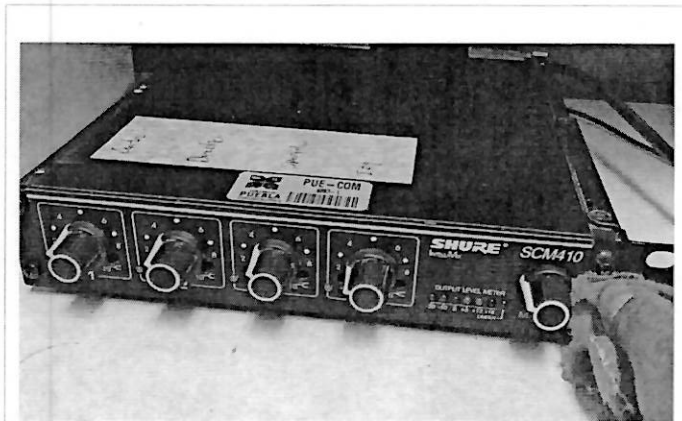
Se prueban los canales de audio, se eliminó el ruido y el hum que estaba metiendo. Queda funcionando bien.
